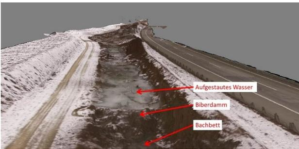
Abbildung 3: 3D-Modell (Oberflächenmodell) eines Bachlaufs mit Biberdamm im Winter.
